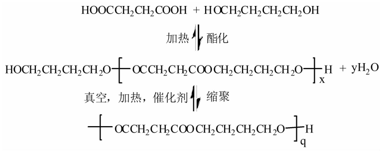
图 2 酯化法合成 PBS 的反应方程式 Figure 2 Scheme of synthesis of PBS by esterification
